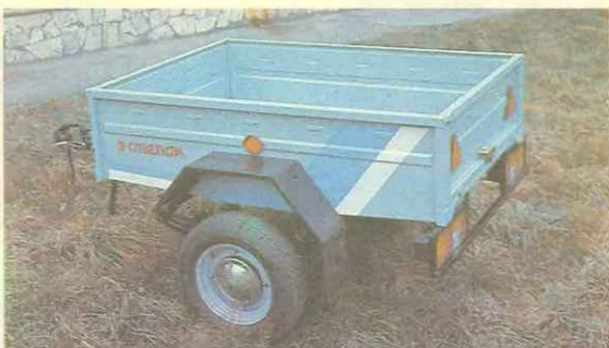
Пятидверный универсал ЗАЗ-1105 практичен и достаточно вместителен [фото слева]. Прицеп «Степок». В его конструкции целиком использована задняя подвеска ЗАЗ-968М.
